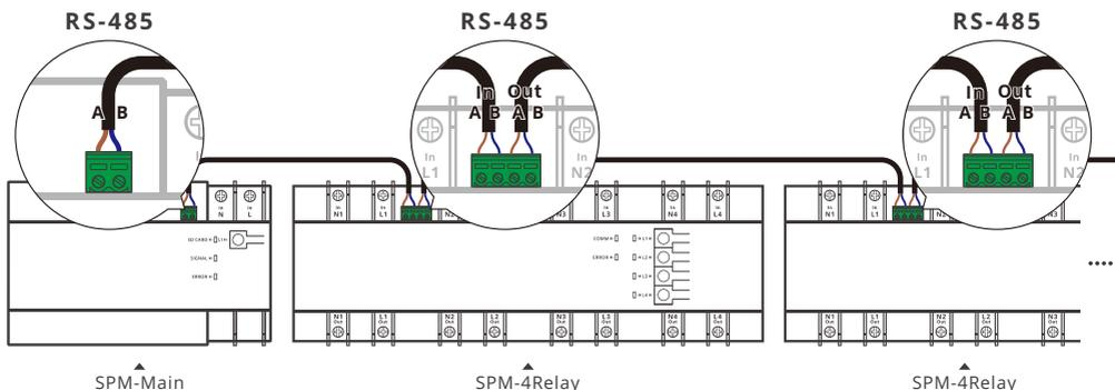
⚠ 每1台主机最多支持接入32台从机(总接线长度不超过100米)。
