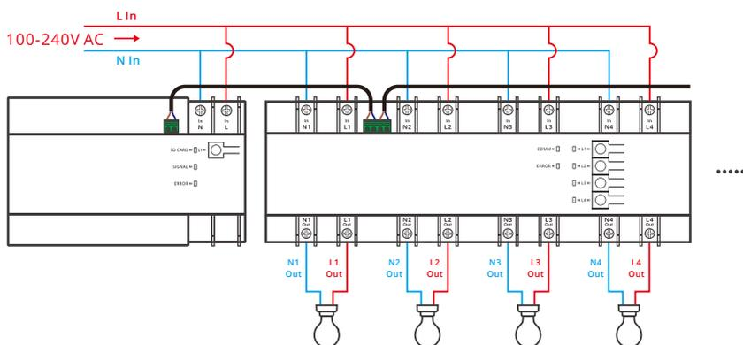
⚠ 从机有4个通道, 由第一通道给设备自身供电, 所以第一通道必须接入电源; 每个通道互相独立, 仅当上方输入端接入电源后, 对应通道才可正常输出。
