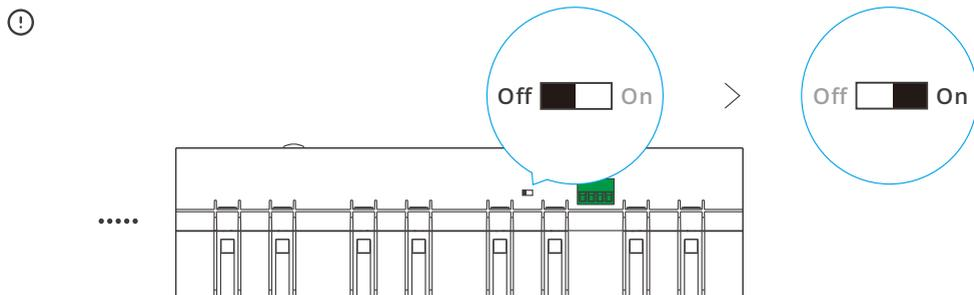
从机的“RS-485末端电阻开关”出厂默认关闭状态。为保证通信稳定，须将最末端从机的“RS-485末端电阻开关”切换至打开状态。
